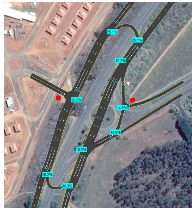
Figura 55 - Exemplo de tráfego no entroncamento durante a simulação no pico da tarde (cenário futuro com duplicação)
