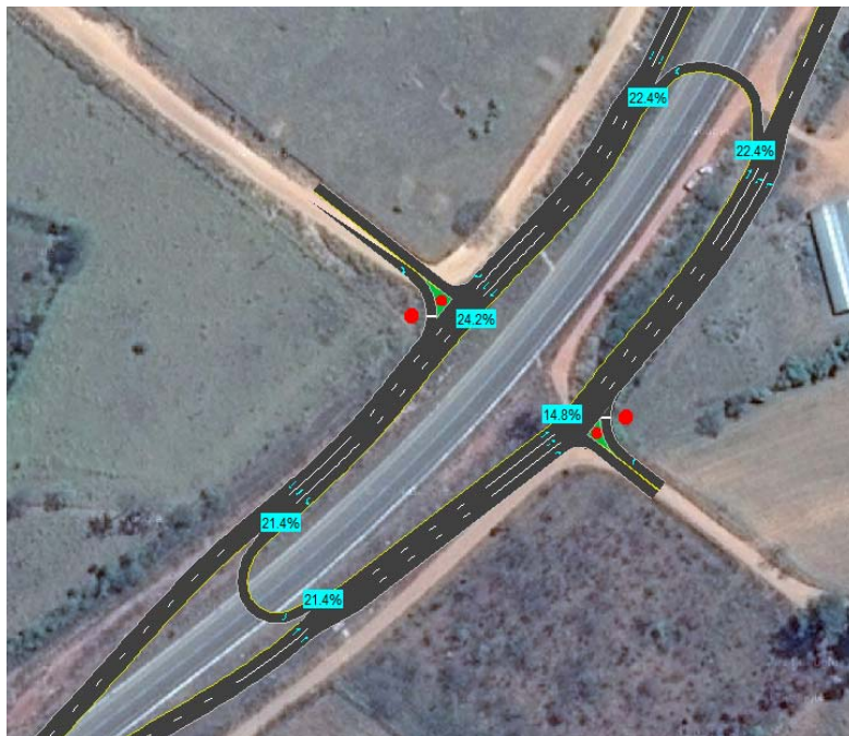
Figura 51 - Percentual de carregamento na conexão da Rua Tenente Coronel Hermenegildo Magalhães com a MG-146 no cenário futuro com duplicação (pico da manhã)
