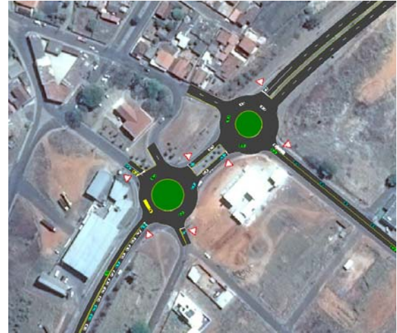
Figura 50 - Exemplo de tráfego nas rotatórias durante a simulação no pico da tarde (cenário futuro com duplicação)
