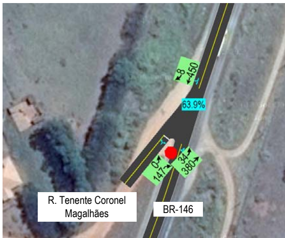
Figura 41 - Percentual de carregamento na conexão da Rua Tenente Coronel Hermenegildo Magalhães com a BR-146 no cenário futuro sem duplicação (pico da manhã)
