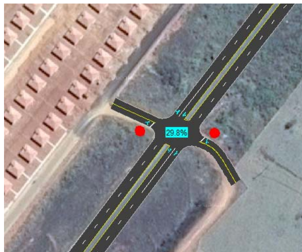
Figura 57 - Percentual de carregamento da interseção no cenário futuro com duplicação em ICU (pico tarde)
