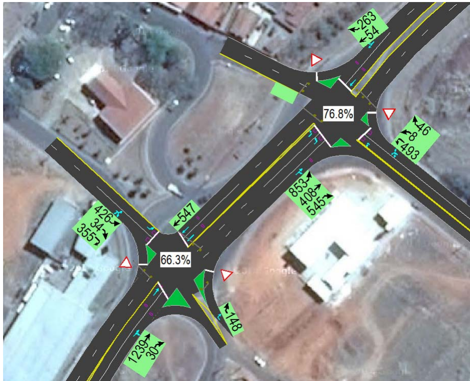
Figura 58 – Intervenção proposta complementar na intervenção da Av. Washington Barcelos, através de operação semafórica. Simulação para o pico da tarde, no cenário futuro com duplicação
