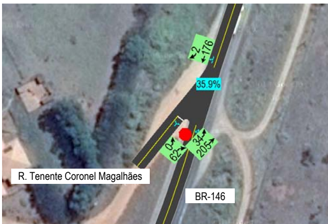
Figura 25 - Percentual de carregamento na conexão da Rua Tenente Coronel Hermenegildo Magalhães com a MG-146 no cenário atual (manhã)
